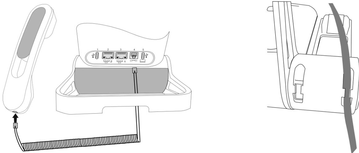
Brancher le combiné filaire au connecteur approprié - numéro de connecteur dans la photo : 4.
